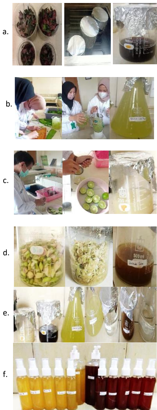
Gambar 2: Proses pembuatan HS; a) ekstraksi daun sirih, b) penyiapan sediaan gel lidah buaya, c) penyiapan air perasan jeruk nipis, d) ekstraksi serai, e) bahan untuk formula HS, f) HS mengandung alkohol dan HS bebas alkohol yang telah jadi
