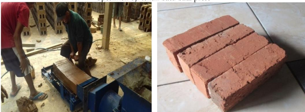
Hasil pengujian batu bata press pada ketiga komposisi campuran untuk uji tekuk. Dimensi spesimen 210 x 110 x 50 mm dengan kuat tekan batubata menurut standar Industri Indonesia SII-0021-1978. Tegangan tekan internal yang ditimbulkan oleh gaya tekan diasumsikan tersebar atau didistribusikan merata keseluruhan penampang batu bata menimbulkan intensitas atau tegangan yang sebenarnya (Sukobar, Kuntjoro,
