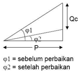
Gambar 1. Upaya Peningkatan Faktor Daya dengan Pemasangan Kapasitor
