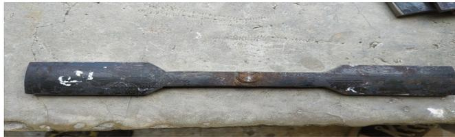
Gambar 3. Spesimen Uji Tarik
