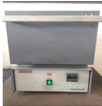
Gambar 2. Tungku Pemanas ( Furnace )
