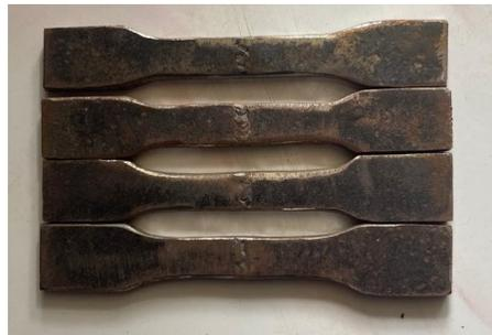
Gambar 7. Spesimen Las Filler ER 70S - 4
