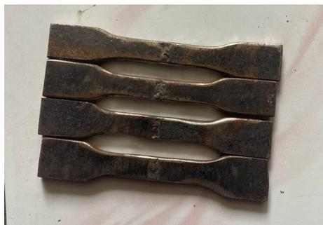
Gambar 8. Spesimen Las Filler ER 70S – 6
