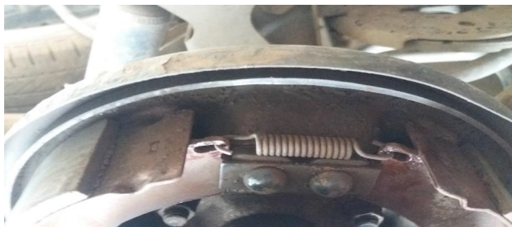
Gambar 17. Posisi elemen mesin pendukung, yaitu pegas rem
