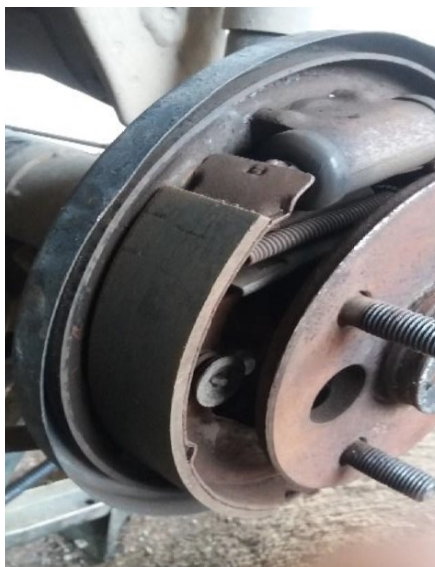
Gambar 17. Posisi kanvas rem dan master silinder
